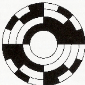
Obr. 9. Stínítko pro 4bitový absolutní snímač polohy
